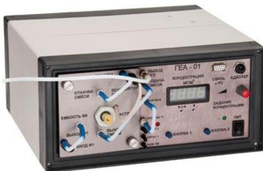
Принцип действия генератора основан на получении газовых смесей (ГС) путем испарения аммиака из его водного раствора с последующим разбавлением воздухом и измерением концентрации аммиака в ГС фотоионизационным детектором (ФИД). В генераторе предусмотрена обратная связь для поддержания заданной концентрации.
